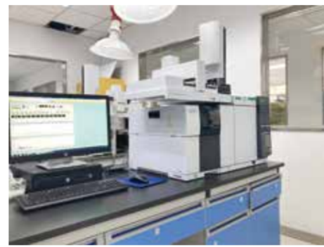
在中国上海科恩检验服务公司设置了偶氮试验用GC-MAS试验机。
