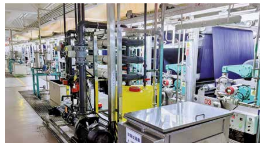
靛蓝在线回用系统可实现靛蓝、水回用率超过95%，染色水洗环节废水近零排放。
